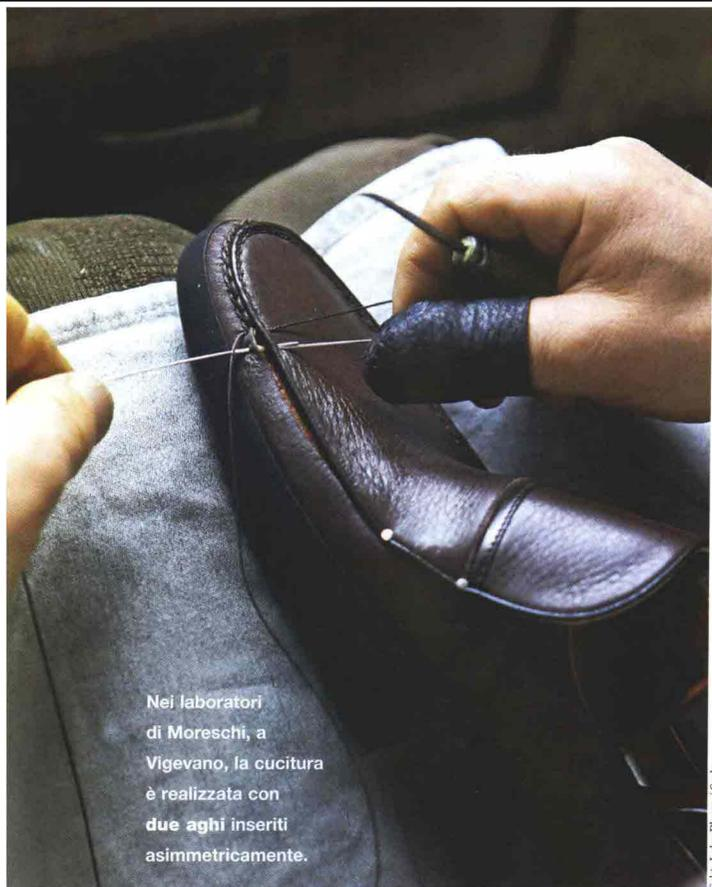
Nei laboratori di Moreschi, a Vigevano, la cucitura è realizzata con due aghi inseriti asimmetricamente.
